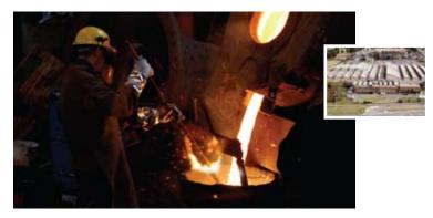
锻造车间的能力包括落锤锻造和自由锻造直径最大至1000mm的各种标准材料和特殊材料,制造成阀盖、法兰、阀塞和阀座环。
